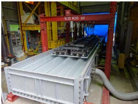
写真1 耐風圧性能試験の様子
